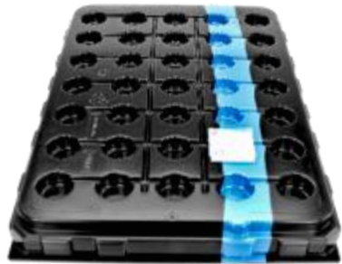
Farbstreifen + werkzeugseitige Außenkontur
