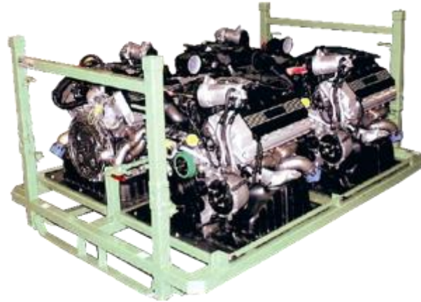
Zwei Trays als Bodenlage bestückt mit zwei 8-Zylinder- Motor im Stahlladungsträger
