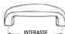
B Maniglia interna in propilene interasse 104, entrata mano 84x24, per vite 4,8x22
